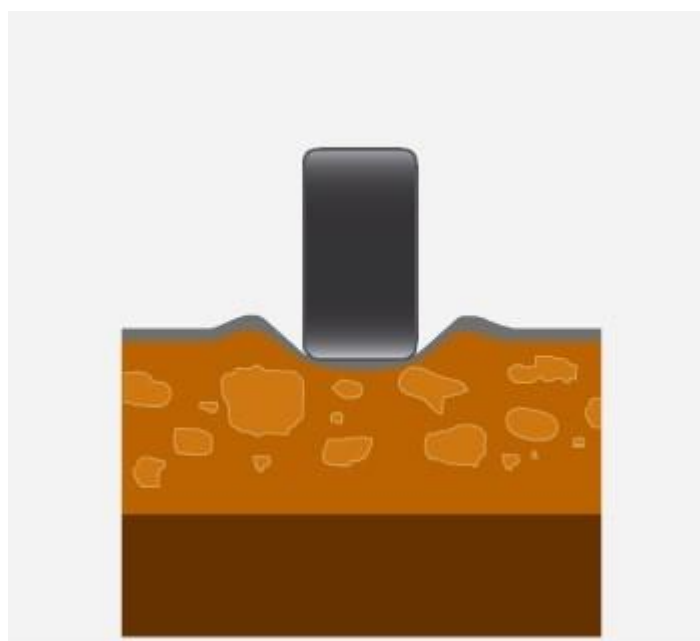
Obrázek 8. Riziko vzniku kolejí typu 1
